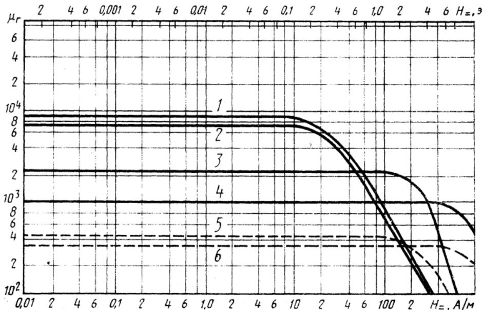
Зависимость обратимой проницаемости от напряженности подмагничивающего поля для сплавов марок:
