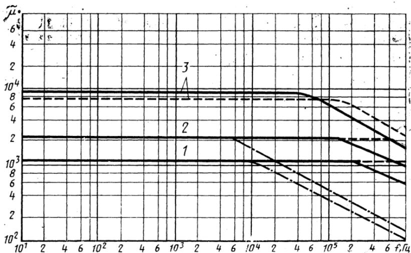
Зависимость начальной проницаемости от частоты для образцов из сплавов марок:
