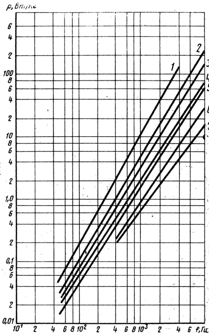
Зависимость  $P_{0,5}$  от частоты для сплавов марок:
