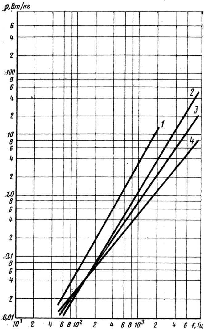
Зависимость  $P_{0,5}$  от частоты для сплавов марок:
